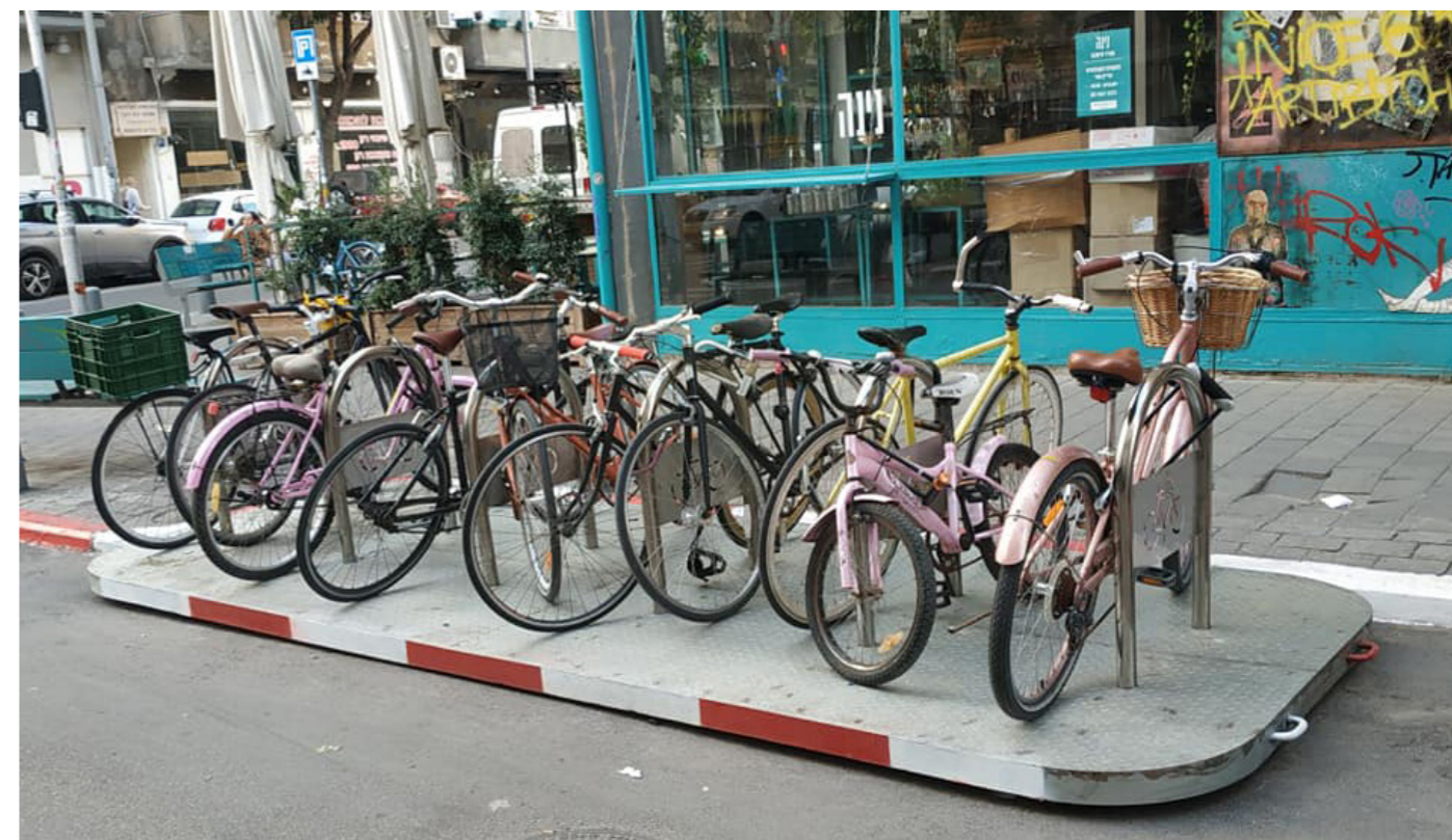
Immagine 03. Esempio di piattaforma temporanea per il parcheggio delle biciclette. Le dimensioni della piattaforma corrispondono a quelle di uno stallone per auto, circa 2x5m (fonte sito: UMo Urban Mobility)
